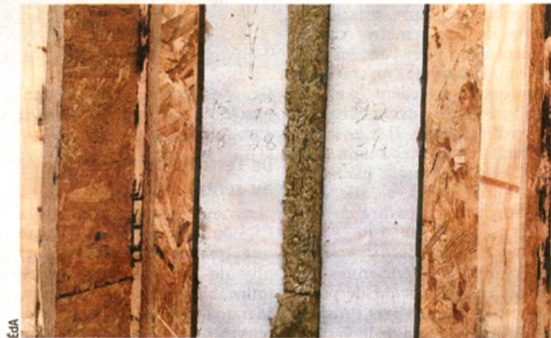
Ça ressemble à des blocs bien connus, mais c'est du silicate dont la compacité offre des performances phoniques étonnantes.
